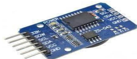
**Fig 6:** RTC module
